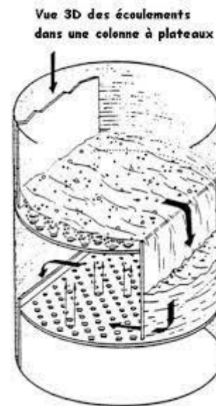
Figure III.1 : L'écoulement dans une colonne à plateaux.
