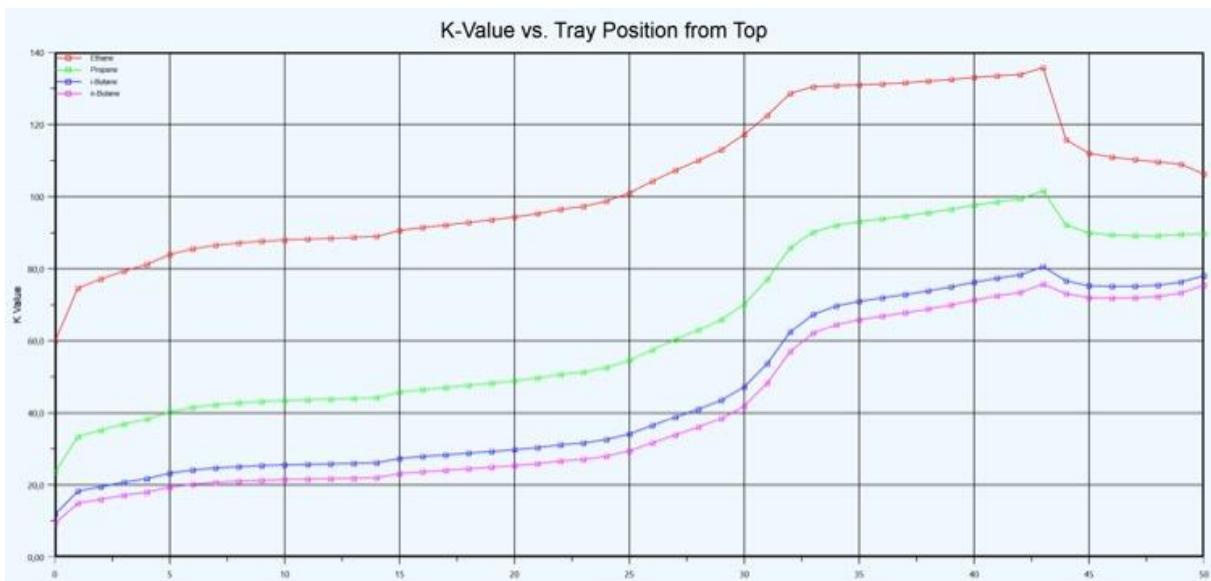
Figure IV.9 : Coefficient K des produits sur chaque plateau de la colonne C101.
