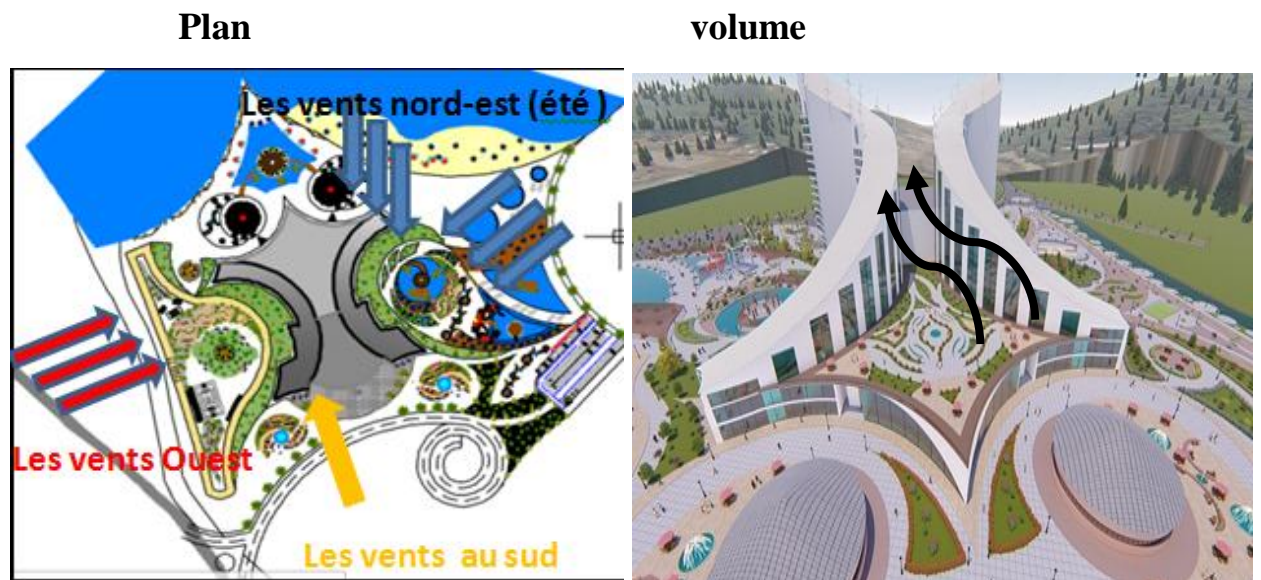
Figure 94 : Schéma du vent entrant est en effet dévié par les tours
