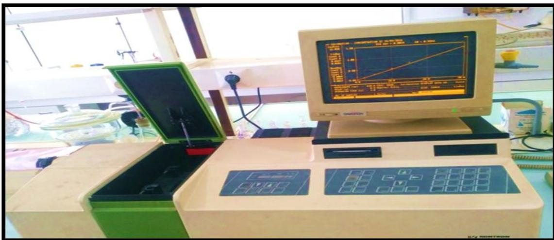
Figure 18 : Spectrophotomètre UV-visible UVICON 430 (Laboratoire d'Hydrochimie)
