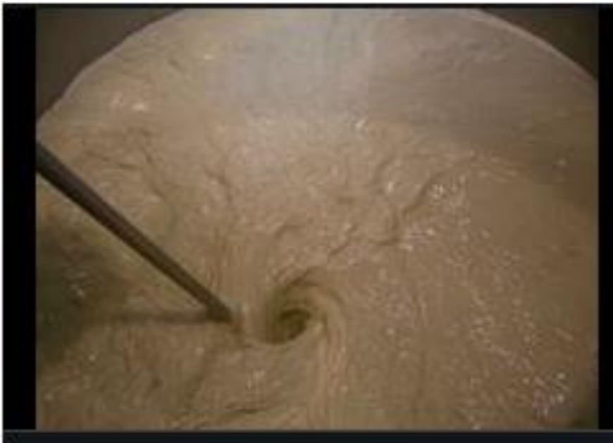
Figure 7 : boue de forage (à base de bentonite)
