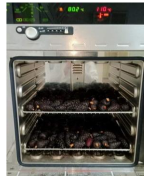
Séchage dans une étuve à 110°C/24h
