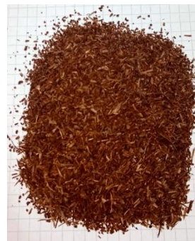
Tamisage (<2mm), lavage et séchage de nouveau à 110°C/24h
