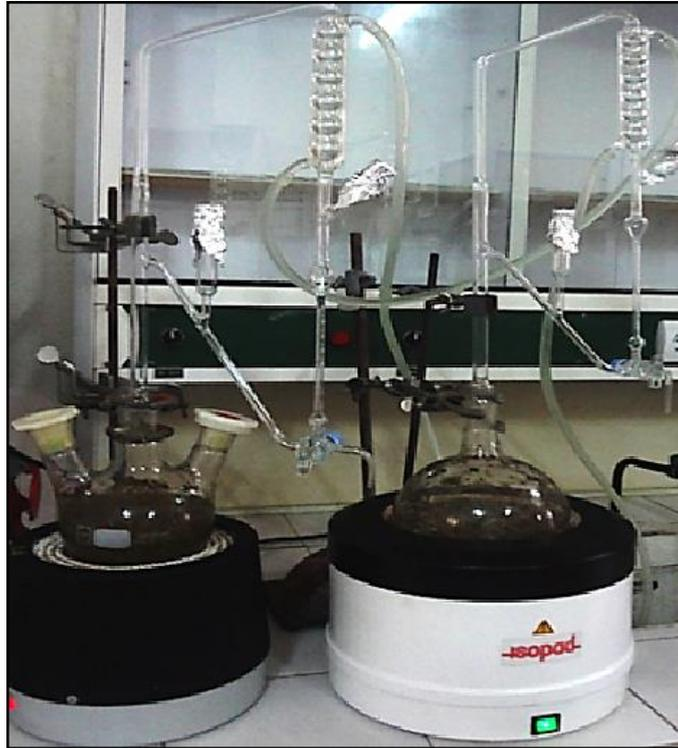
Figure 2.3 : Montage de l'hydrodistillation (type Clevenger).
