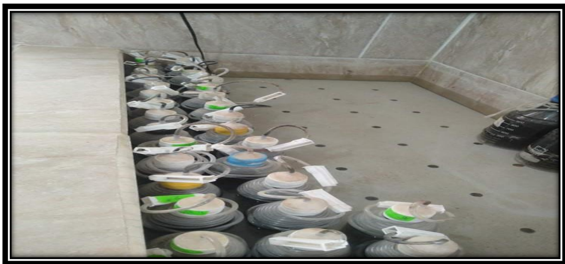
Figure 3.7 : Photo des réacteurs dans un bain marie chauffer et régulé à 37\text{ °C} .
