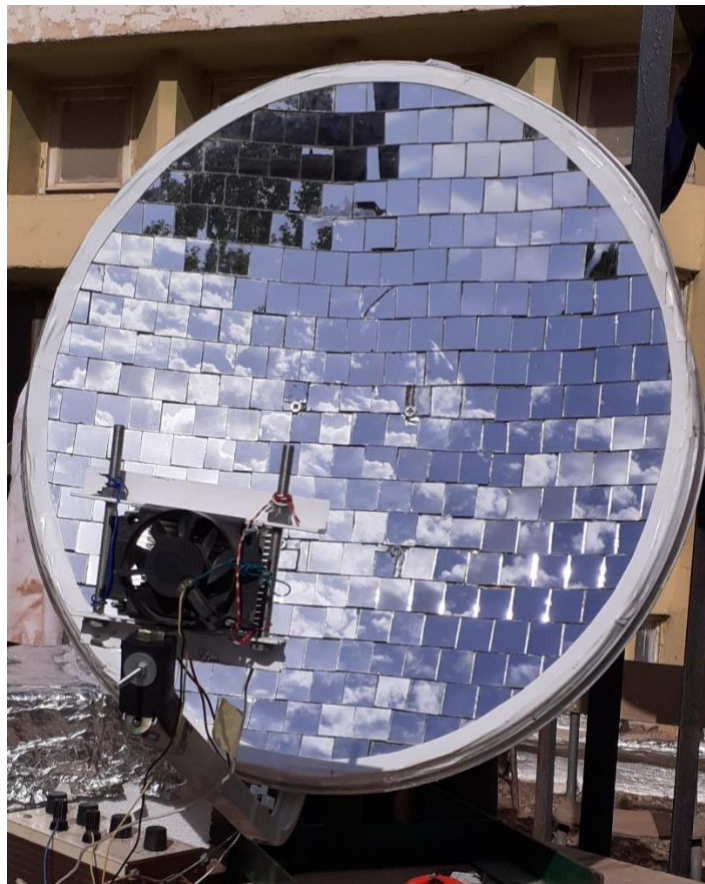
Figure (III.1) : le concentrateur solaire.
