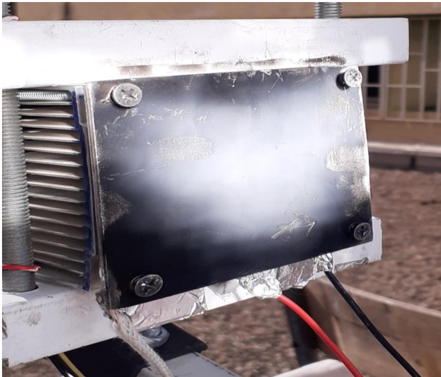
Figure (III.3) : la plaque réceptrice du système (le coté chaud).
