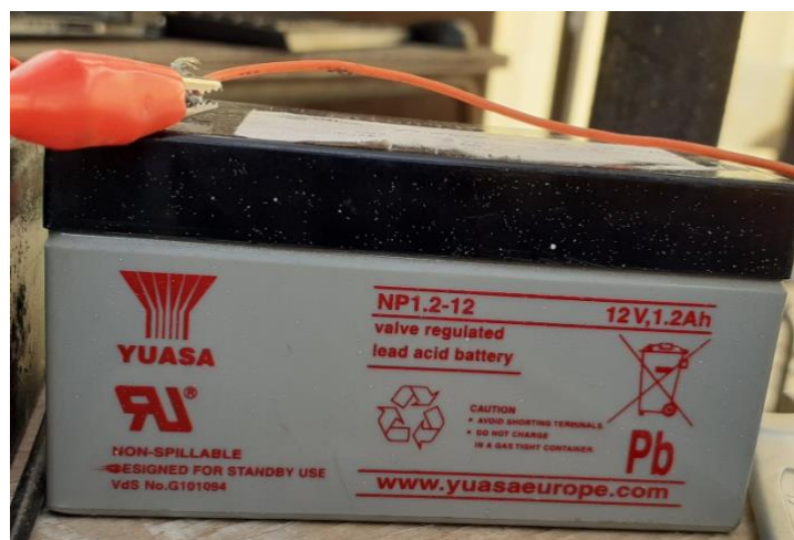
Figure (III.7) : la batterie du dissipateur de chaleur.
