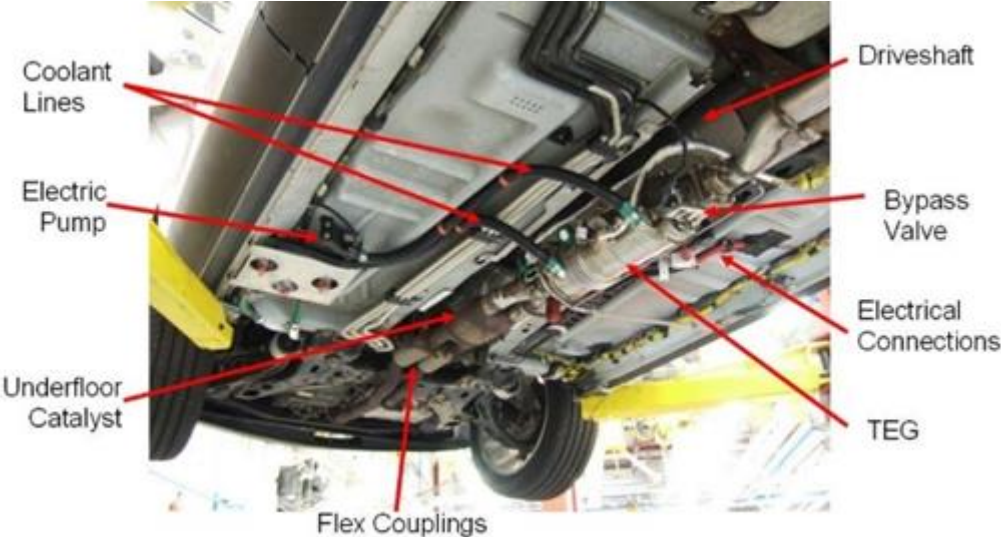
Figure I.16 Intégration du TEG dans la ligne d'échappement du véhicule prototype BMW X6[74].
