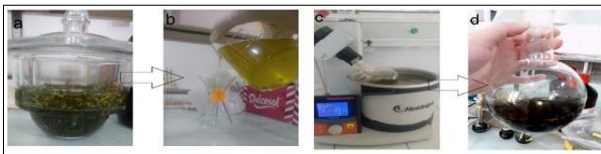
**Figure 19** : *Protocol de l'extraction : (a)- Macération ; (b)- Filtration ; (c)- Distillation sous-vide ; (d)- L'extrait sec.*
