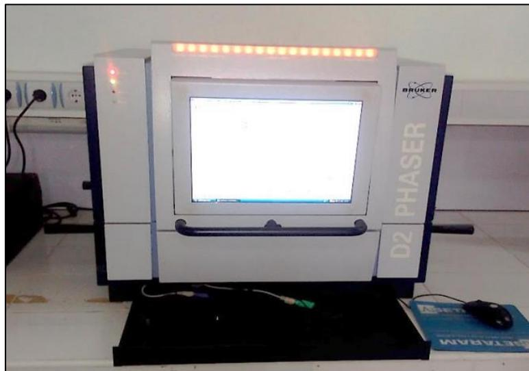
*Figure 14 : DRX BRUKER D2 PHASER (le DRX utilisé).*
