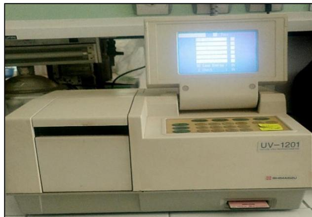
*Figure 12 : Spectrophotomètre SHIMADZU UV-1201 (le spectrophotomètre utilisé).*
