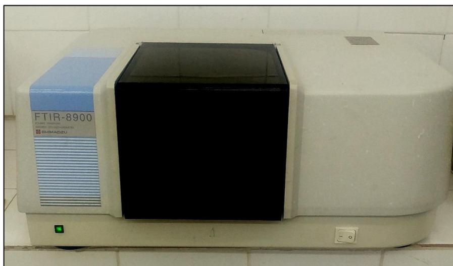
*Figure 15 : Spectromètre infrarouge SHIMADZU FTIR-8900 (le spectromètre utilisé).*
