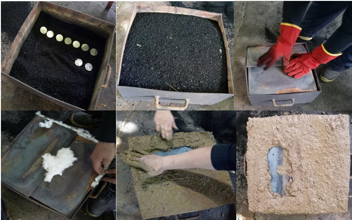
Figure III.4 : Préparation de la caisse cémentation.
