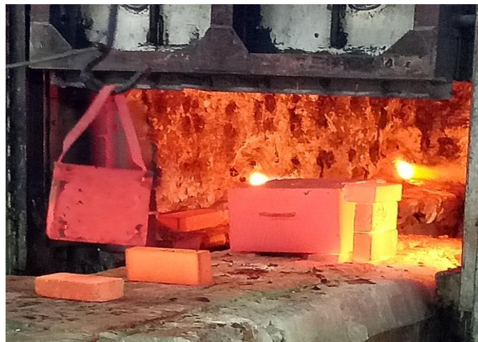
Figure III.8 : La caisse à la sortie du four.
