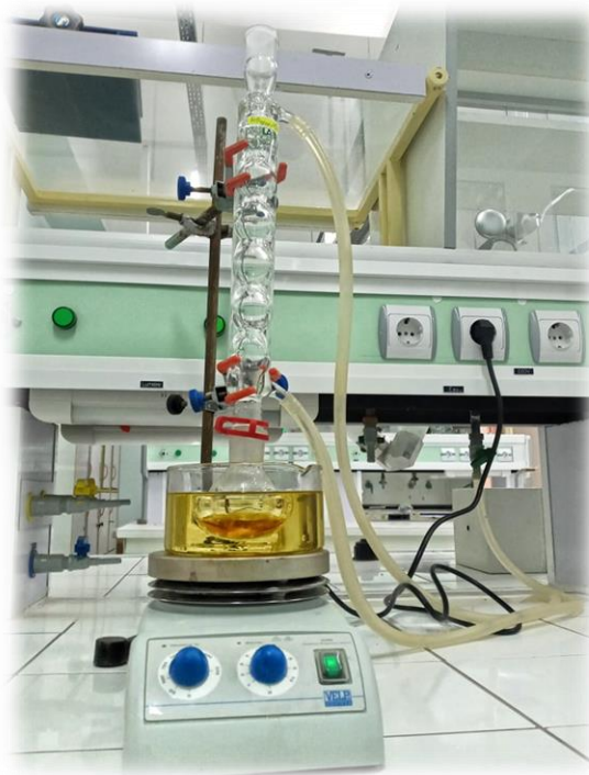
Figure II-7 : Montage de préparation de solvant eutectique profond.
