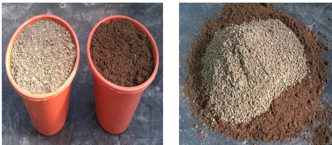
Figure 4.6 : Préparation du mélange tourbe-sable.
