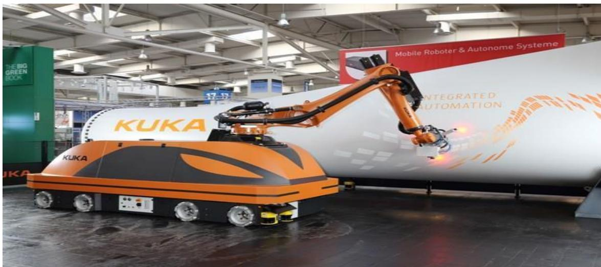
Figure. I.4 : Cellule robotisée Mobile. [10]
