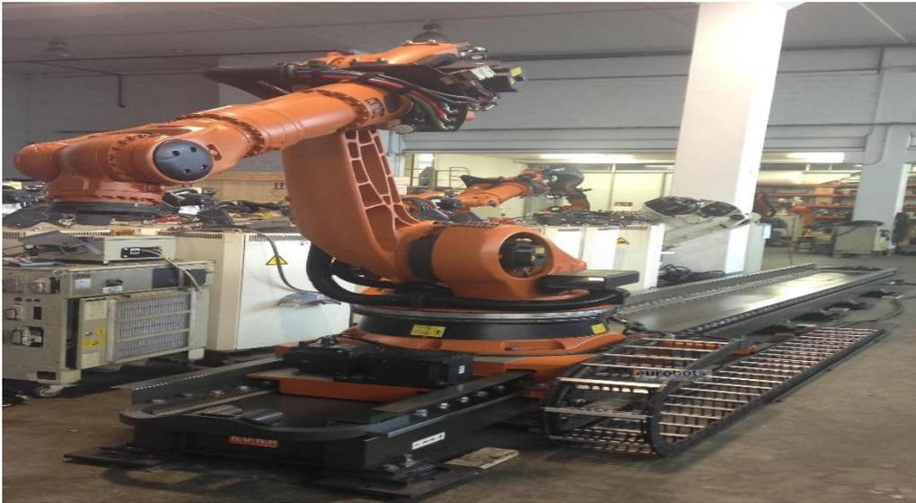
Figure. I.3 : Cellule robotisée linéaire [11].
