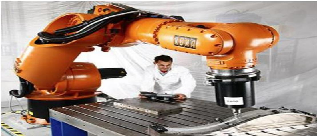
**Figure 1. 8 : Cellule flexible de soudage par friction-malaxage. [9].**
