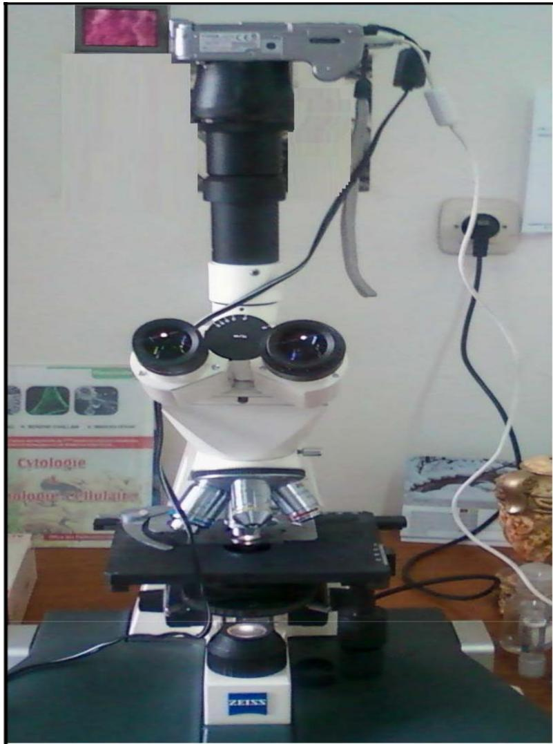
**Figure 25** : Microscope photonique avec l'appareil numérique
