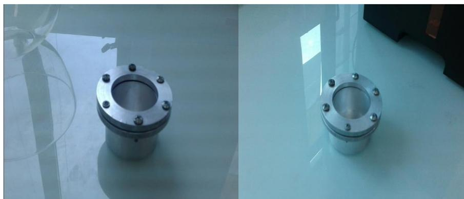
**Figure 2.6 :** Photo du perméamètre.
