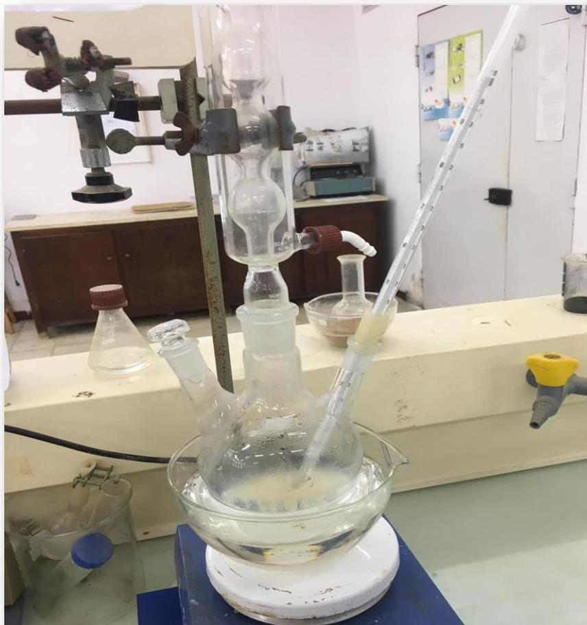
**Figure 3 :** Dispositif expérimental utilisé pour le chauffage a reflux du mélange (alginate de sodium et l'urée)
