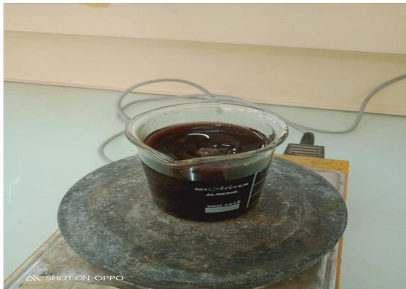
**Figure 4** : Solution d'alginate modifiée et cobalt ferrite sous agitation
