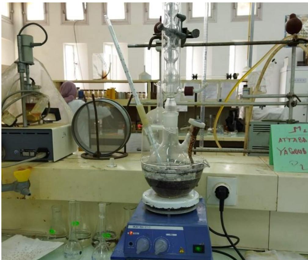
**Figure II.2 :** Montage expérimental pour la synthèse du cobalt ferrites
