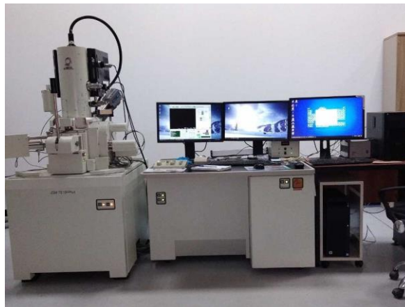
Figure 2.2: Microscopie électronique à balayage JEOL JSM-7610FPlus (CRTSE)
