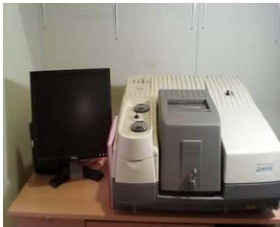
Figure 2.3 : Spectroscopie Infrarouge à Transformée de Fourier (FTIR/ATR) Thermo Nicolet NEXUS 670
