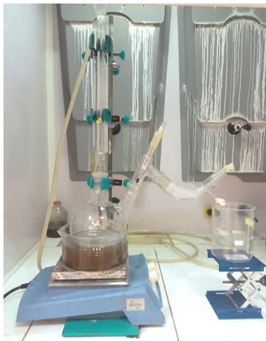
Figure 2.9 : Schéma d'un montage sous reflux de dissolution alcaline du silicium
