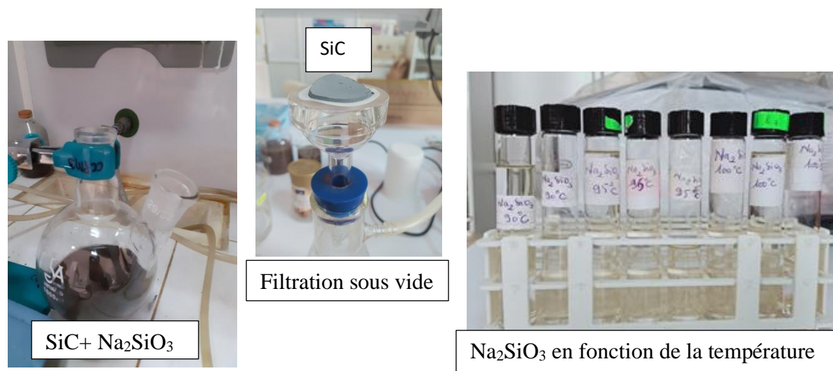
Figure 3.6 : formation de solution de silicate de sodium en fonction de la température de dissolution.
