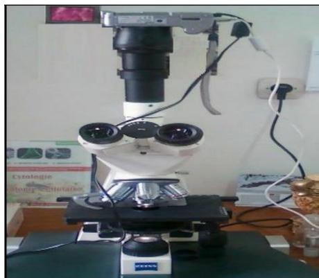
**Figure 28** : Microscope photonique avec l'appareil numérique
