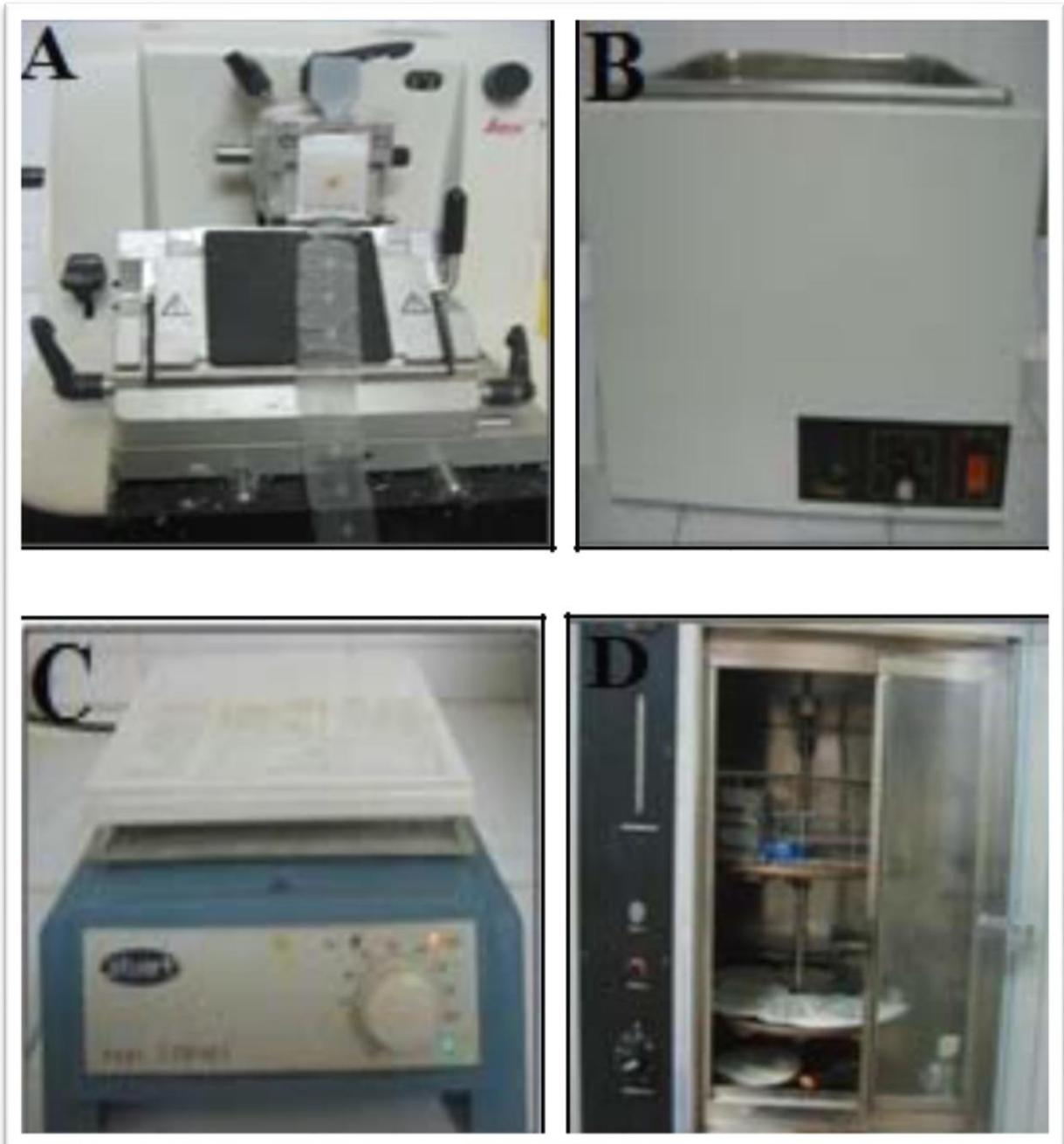
**Figure 25** : Microtomisation et l'étalement des coupe
