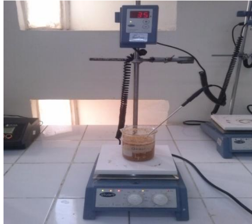
Figure III.3 : Photo du montage de l'extraction par décoction
