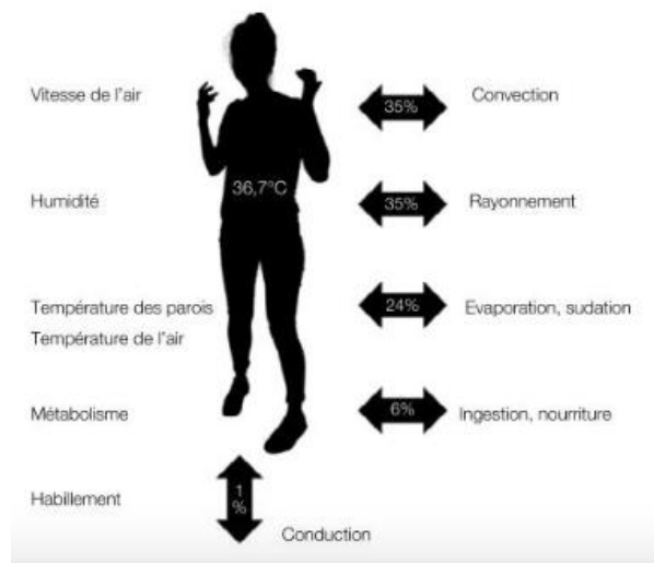
Figure 1.10 : Schéma des échanges thermiques.
