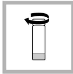
2. Fermer l'éprouvette de réaction immédiatement. Ne pas retourner.
