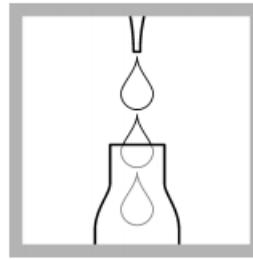
3. Pipetter soigneusement 0.2 mL d'échantillon.
