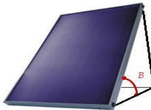
Figure II- 4 : schéma qui montre l'angle d'inclinaison dans un capteur thermique
