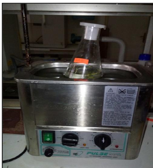
Figure 29 : prétraitement de *L. stoechas* dans un bain à ultrasons.
