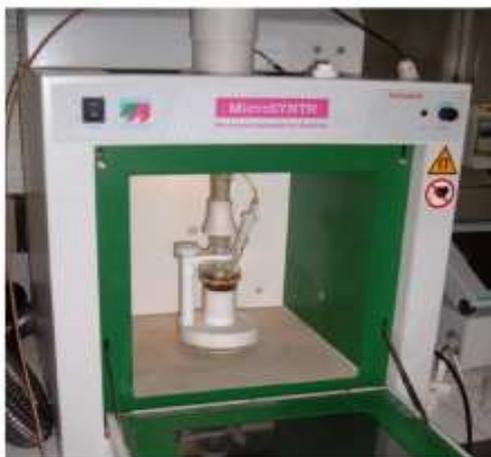
Figure 24 : Combinaison des micro-ondes et des ultrasons (Chemat et *al.*, 2017a).
