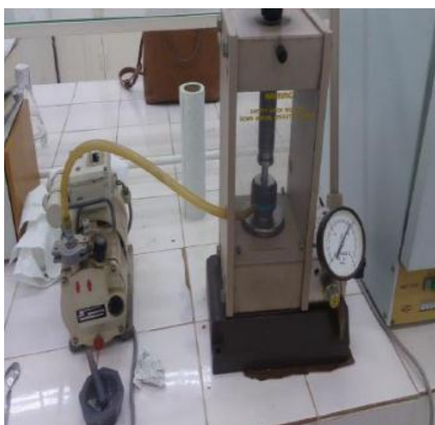
Figure A.10: pastilleuse de laboratoire pour Préparation les échantillons Analysés en Spectroscopie infrarouge (FTIR)
