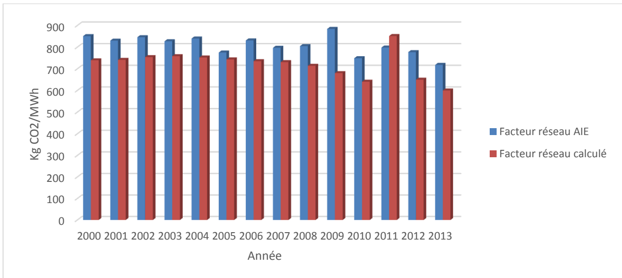
Figure III.14: Comparaison entre le facteur de l'AIE et le facteur réseau calculé de l'Algérie (2000/2013)
