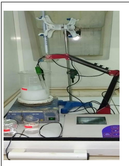
Figure II.1: Montage de synthèse D'hydroxyapatite.
