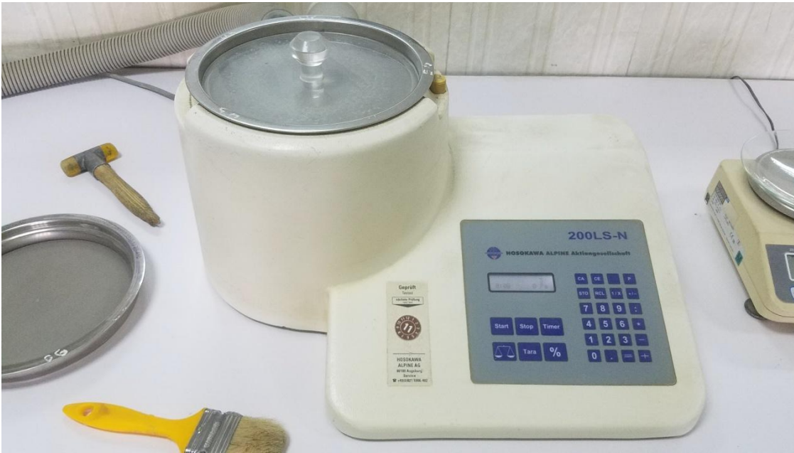
Figure II.6 : Photographies numériques montrant l'appareil refus par tamisage ALPINE
