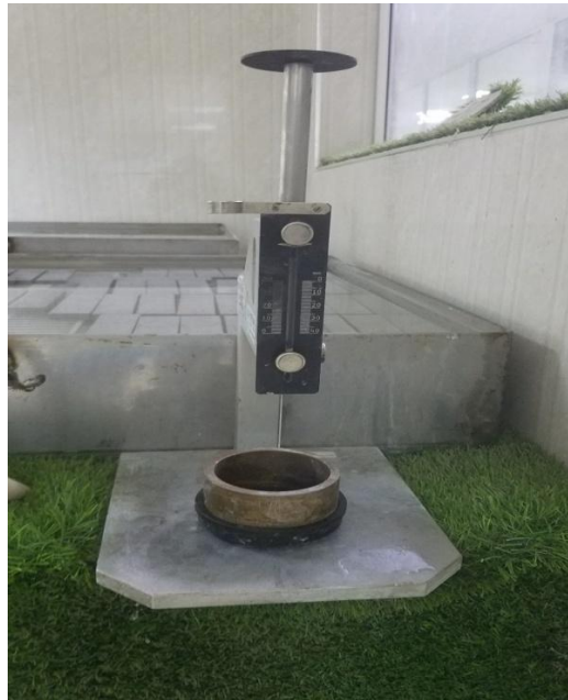
Figure II.10 : Photographies numériques montrant l'appareil de Vicat
