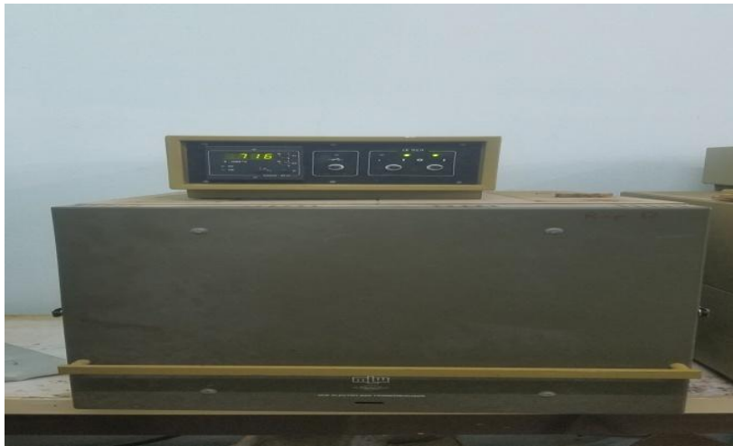
Figure II.3 : Photographies numériques montrant le four de calcination.
