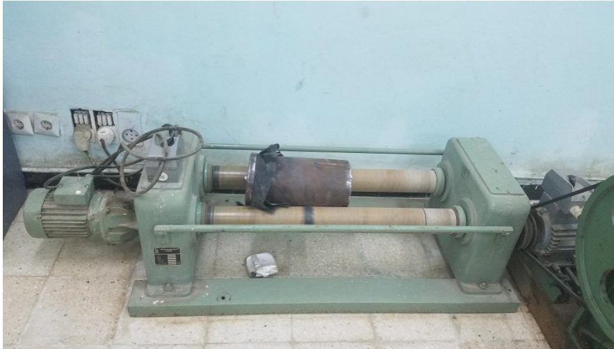
Figure II. 4 : Photographie numérique montrant le Broyeur à boulet .
