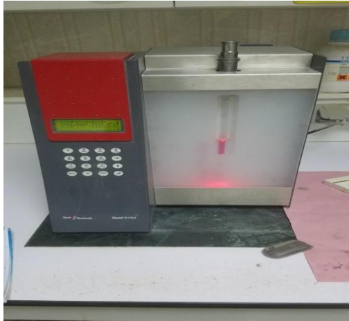
Figure II.5 : Photographie numérique montrant l'appareil Blaine
