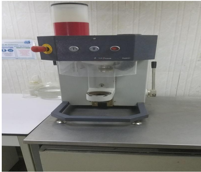
Figure II.8 : Photographies numériques montrant l'appareil de Malaxage.
