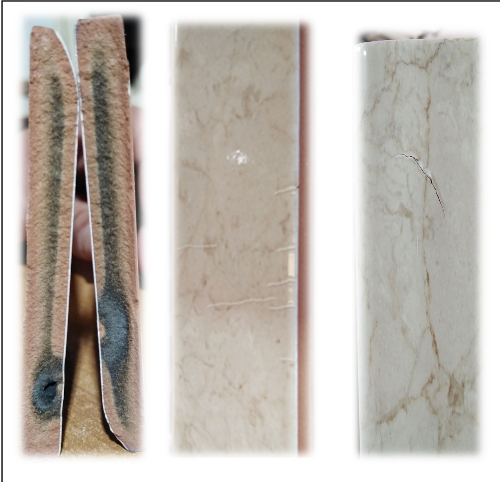
Figure IV.7 : photo numérique montrant le défaut de produite finie (cœur noire, des fissures).
