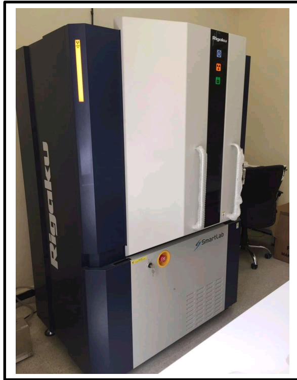
Figure III.7. Photo numérique montre Appareille DRX SMARTLAB
