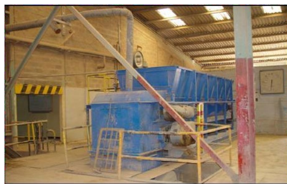
Figure II.2 : Photo numérique montrant le doseur linéaire.
