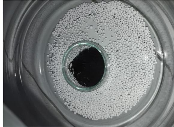
**Figure 3.3** : refroidissement dans le dessiccateur.
