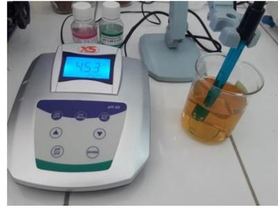
**Figure 3.5** : mesure du pH du filtrat
