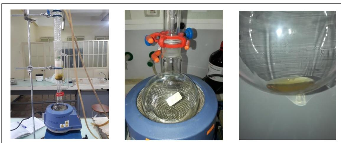
**Figure 3.9** : Extraction d'huile de noyaux de datte par soxhlet.
