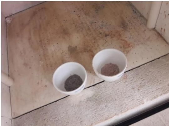
**Figure 3.7:** poudre de noyaux de dattes avant le four à moufle.
