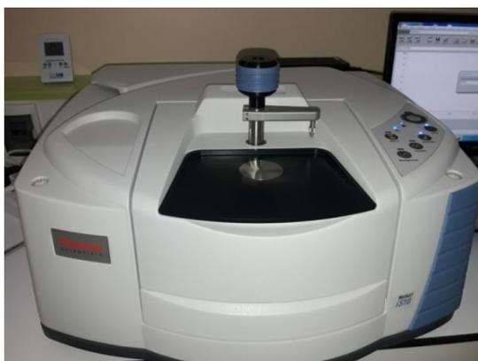
**Figure 3.15** : Appareil d'analyse ATR-IRTF
