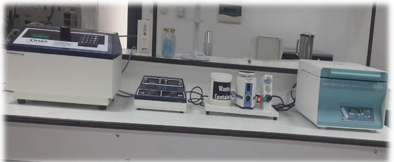
Figure 34 : Dispositif de la RRA (Charm II 6600/7600 Analyzers)
