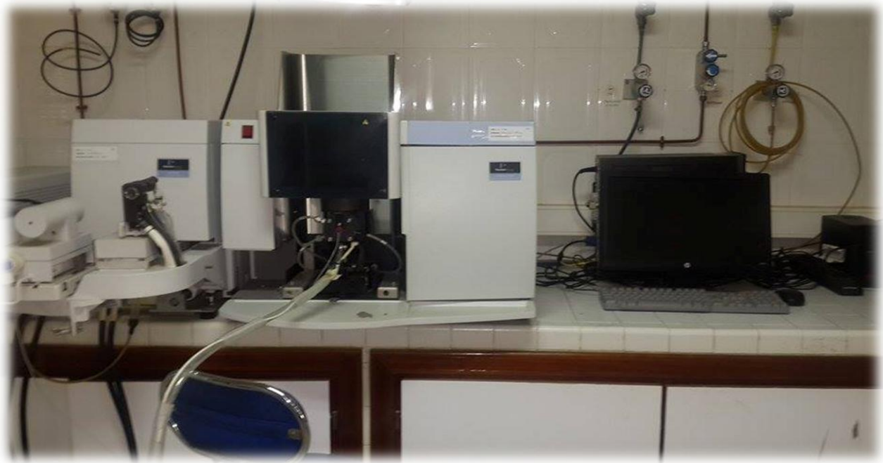
Figure 33 : Spectromètre d’Absorption Atomique (SAA) A 400 PERKIN ELMER
