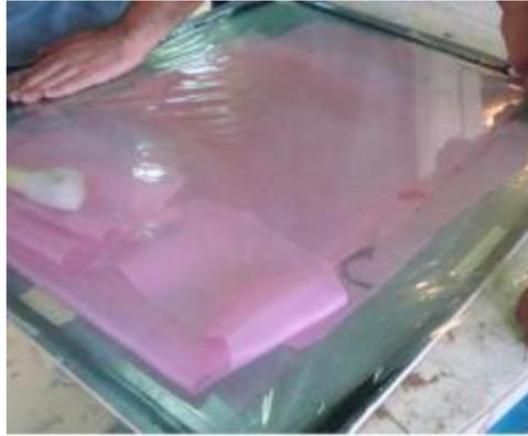
Figure 2-7 l'application du tissu d'arrachage et du nylon.
