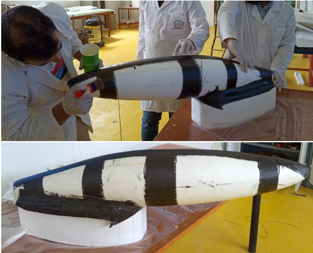
Fig IV.15 : Revêtement du fuselage avec composite
