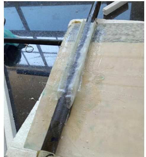
Revêtement de la poutre Avec composite
