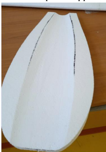
Découpe du support de L'aile Centrale
