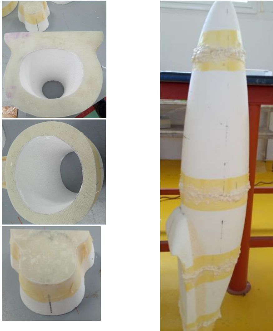
Collage des cadres entre les parties de fuselage
