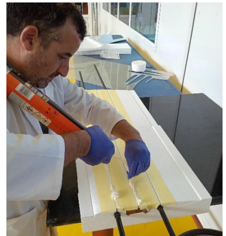
Remplissage des vides par La mousse
