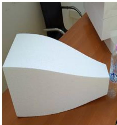
(b). La partie arrière du fuselage
