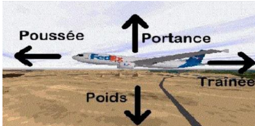
Fig II.13: Les forces exerçant sur l'avion
