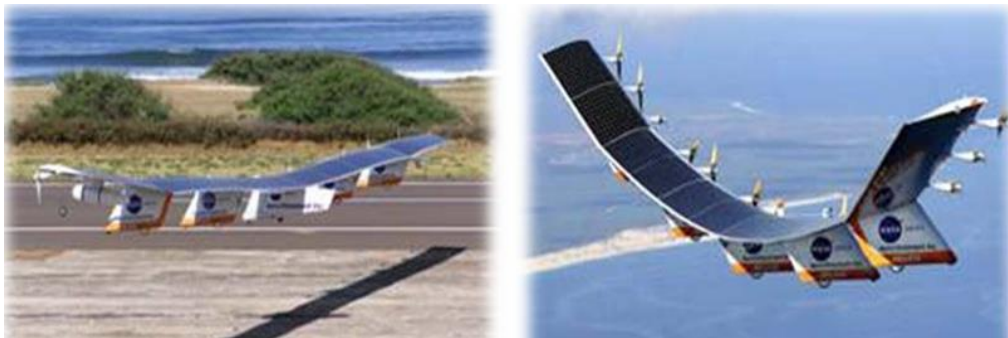
Fig I-10 drone à autonomie (presque) infinie : le projet HELIOS à panneaux solaires
