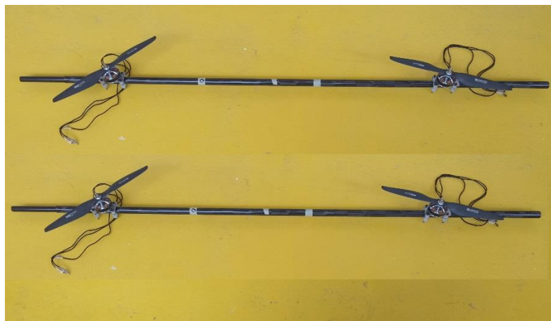
Fig IV.28 : Fixation des moteurs sur les poutres
