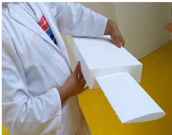
La découpe de l'empennage horizontale
