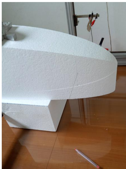
(d). Le découpage de l'avant du fuselage
