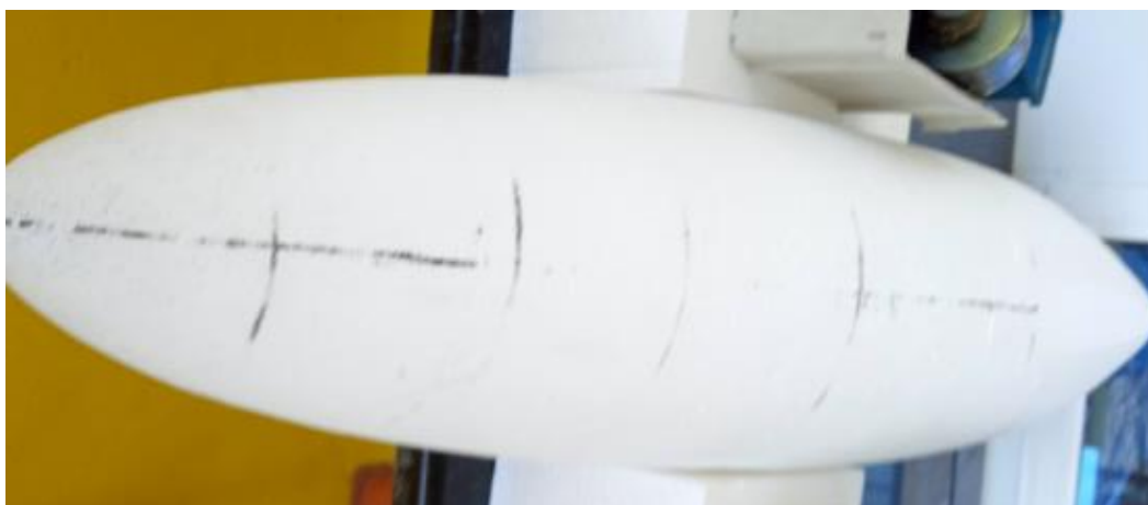
Fig IV.11 : Fuselage après pansage
