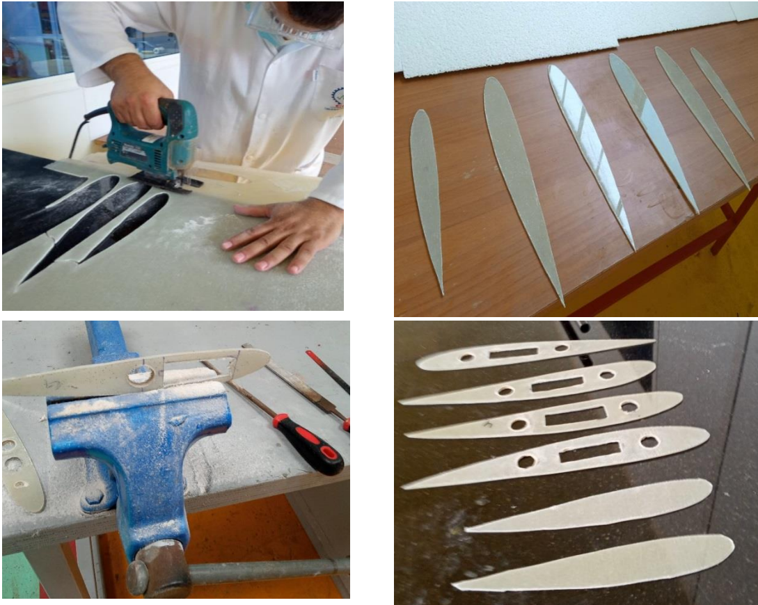
Fig IV.20 : Découpage et finition des nervures
