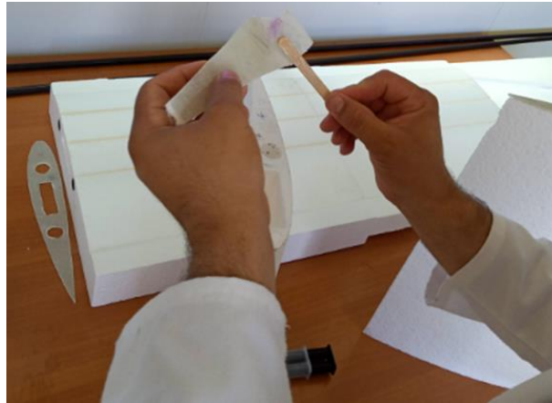
Fig IV.21 : fixation des nervures sur les côtés de l'aile
