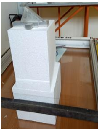
(a). La découpe de l'arrière du fuselage
