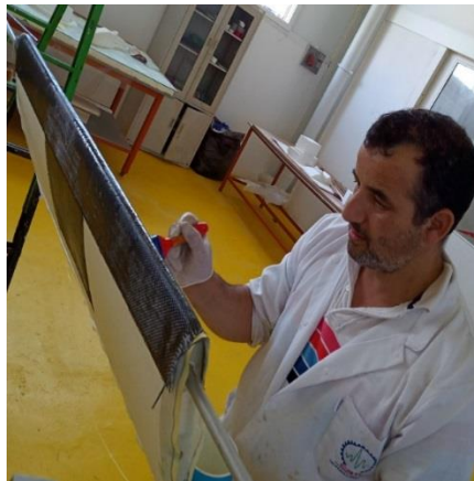
b) Revêtement les bords d'attaque avec de fibre de carbone
