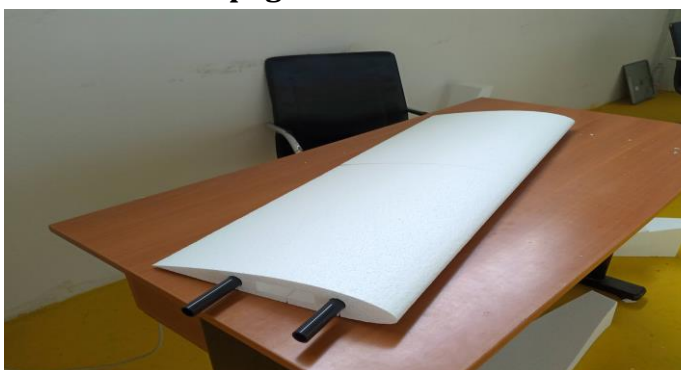
L'aile centrale avec longerons
