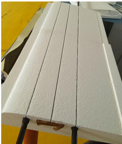
L'effet du fil chaud sur l'aile
