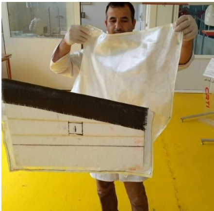
a) Revêtement de l'aile avec de fibre de verre
