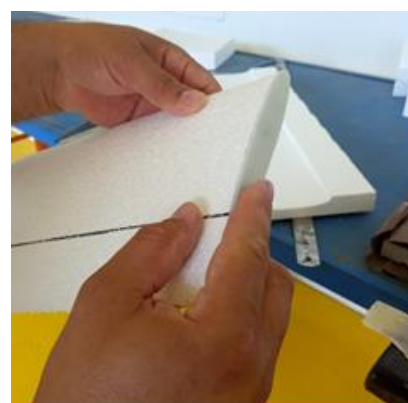
Fig IV.31 : Découpage et collage des nervures d'empennages
