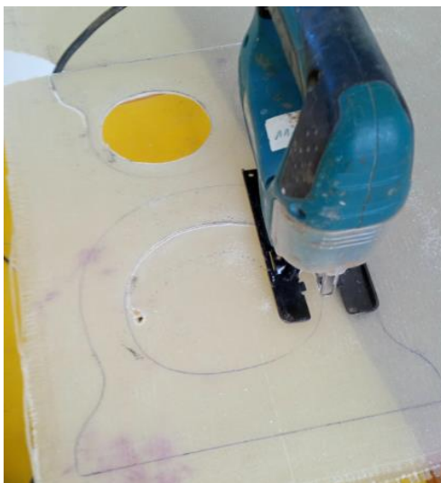
(a) Traçage des cadres de fuselage sur la Plaque en composite
