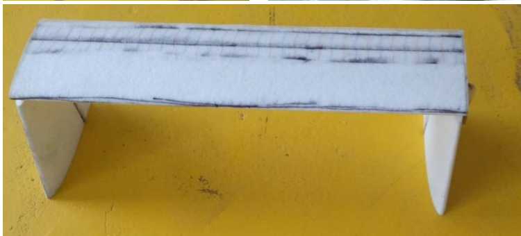
Fig IV.33 : Empennage complet après revêtement et passage câblages
