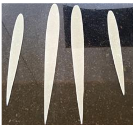
Fig IV.31 : Découpage et collage des nervures d'empennages
