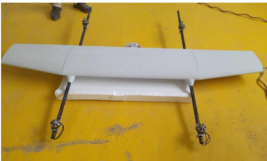
Fig IV.29 : Aile avec les moteurs
