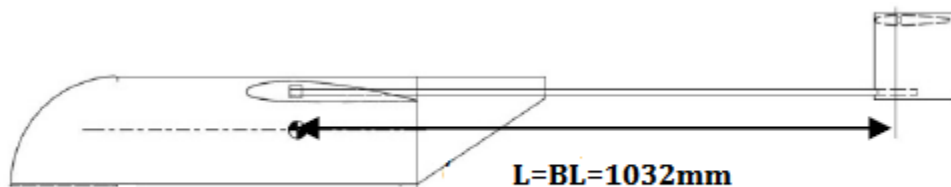
Fig III. 25 Bras de levier des empennages
