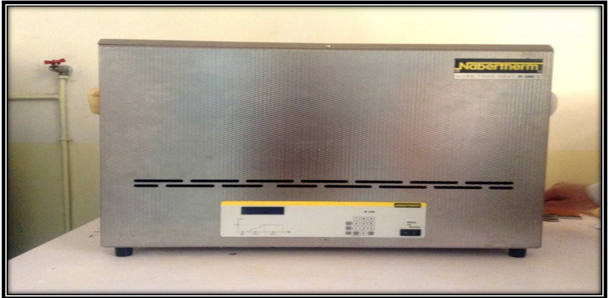
Figure 4.2 : four thermique utilisé ( Nabertherm B180 )
