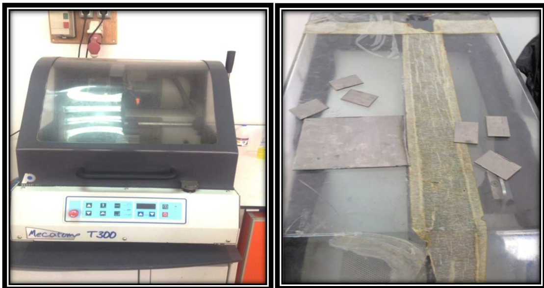
Figure 4.1 : Machine de découpage (PRESI Mecatoms T300) et échantillons coupés
