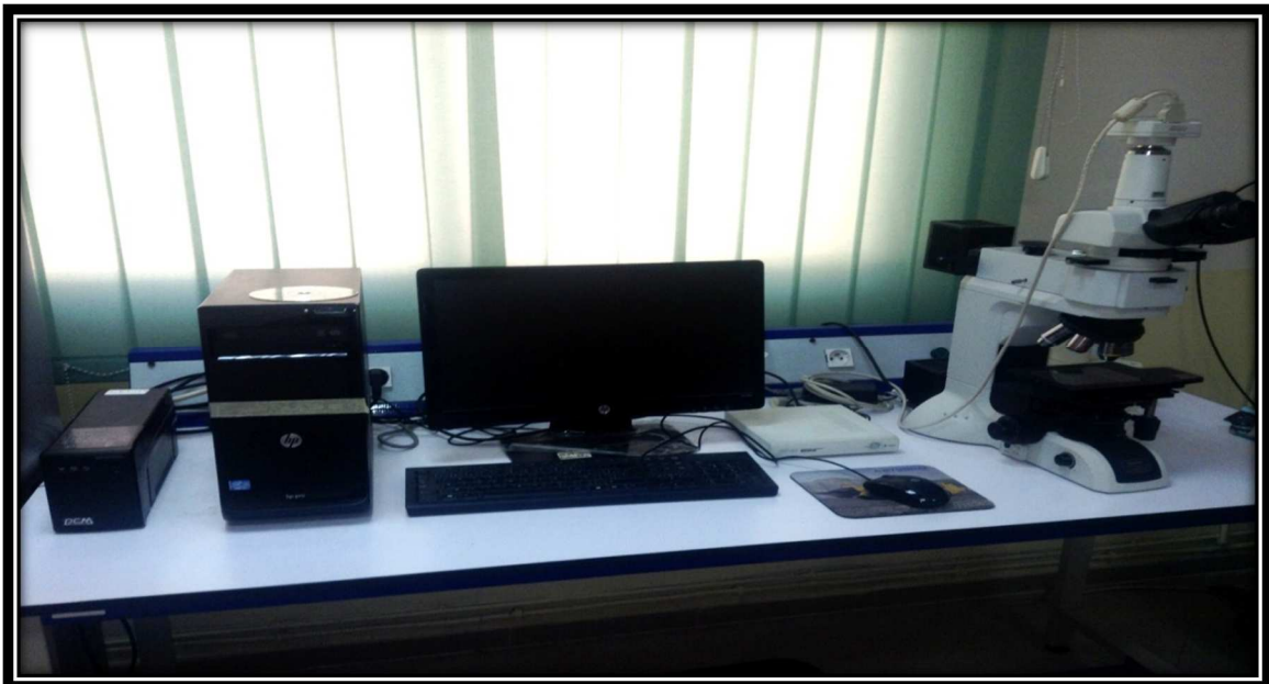
Figure 4.6 : Appareillages de l'observation de la microstructure des matériaux
