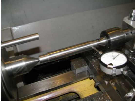
FIGURE 4.11 – Fabrication de l'arbre
