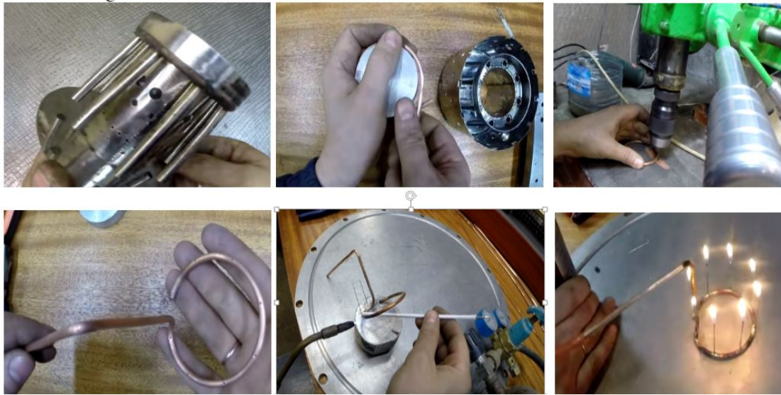
FIGURE 4.10 – Fabrication des tubes de vaporisation et les Injecteurs de carburant
