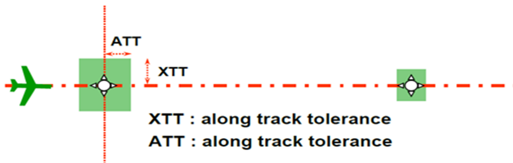
Figure 3.9 : Tolérance d'un waypoint (XTT, ATT) [1]
