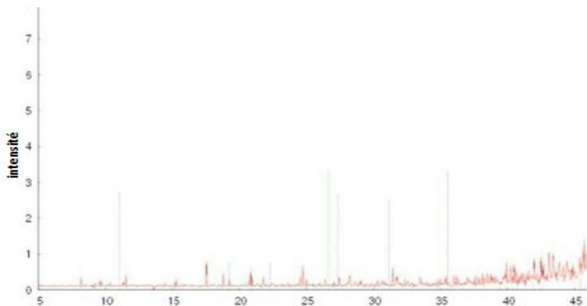
Figure 22: Diffraction des rayons X de la kératine en poudre [79]
