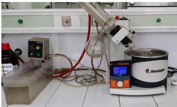
Chauffage à 80°C et agitation de mélange DMSO avec farine de plumes.
