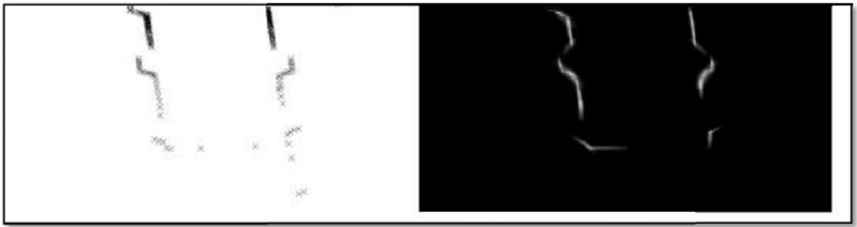
**Figure 3.1** : Un scan laser 2D d'une partie d'un couloir (représenté en tant que points sur la gauche) et la distribution normale (à droite). Chaque cellule est un carré de 0,5 m de côté, la zone la plus blanche représente une plus forte probabilité
