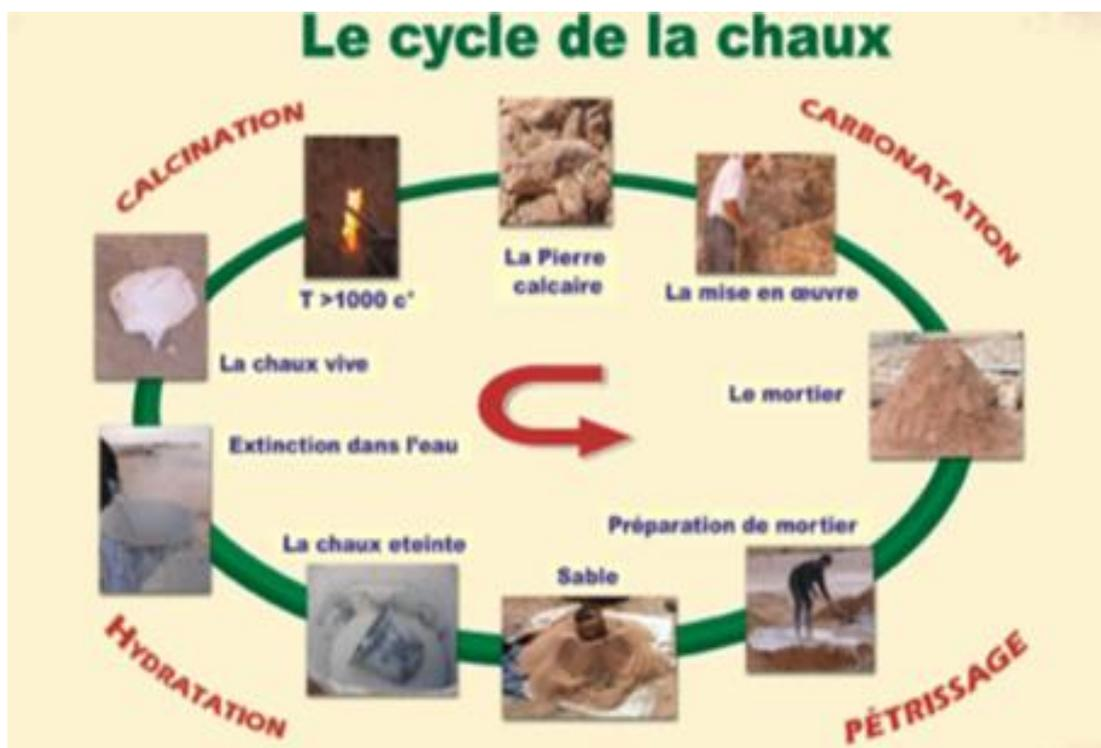
Figure (1.16) : Méthode traditionnelle de préparation du mortier de chaux aérienne,[17]
