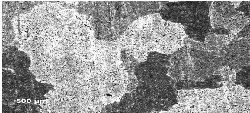
Figure 4.1 : Micrographie optique de l'alliage AA6061 révélant les joints de grains
