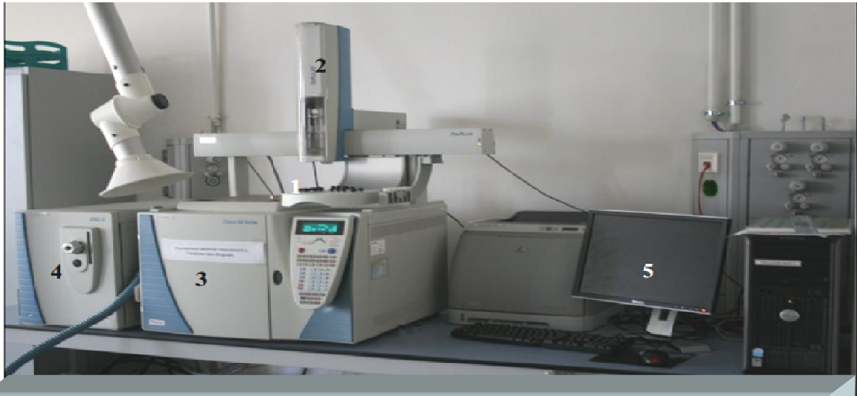
Figure 5: Chromatographie en phase gazeuse couplée à un spectromètre de masse (GC/MS) 1: Porte échantillons, 2: Echantillonneur automatique, 3: Compartiment de la colonne, 4: Spectromètre de masse, 5: Enregistreur.
