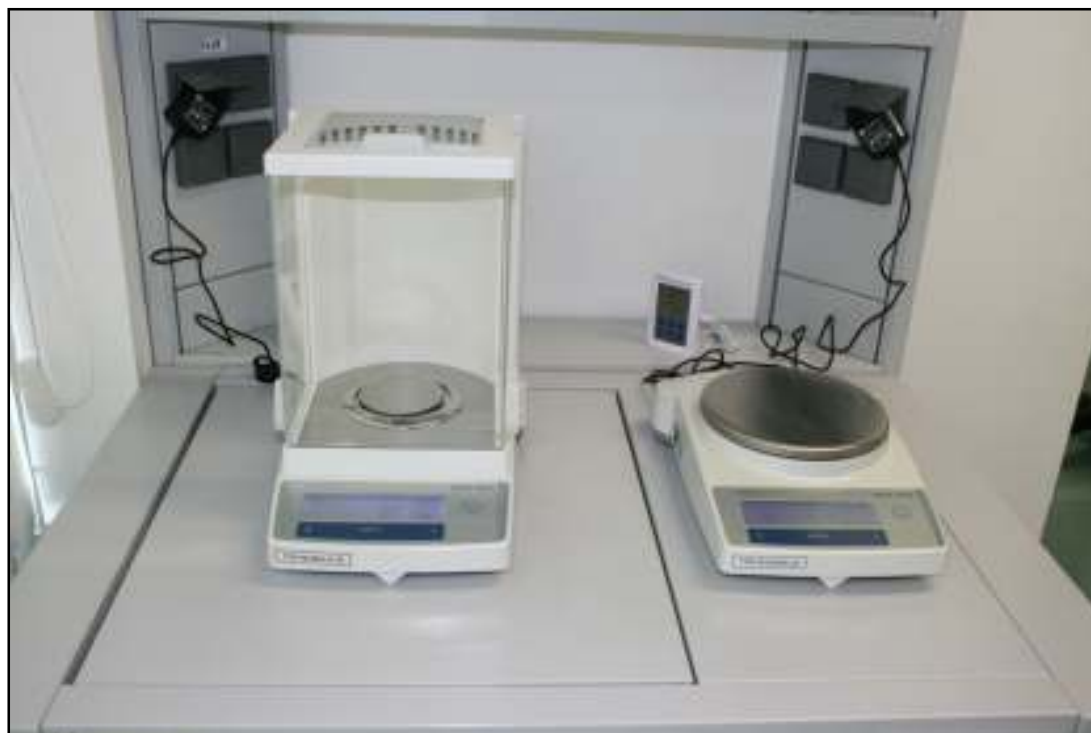
Figure 18: Micro balance (METTLER TOLEDO) dont la sensibilité est de 1mg
