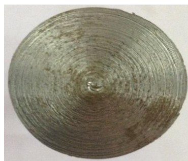
Figure 3.1: Exemple d'un phénomène de broutement
