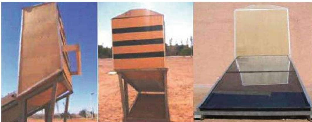
Figure A.5 : Système de séchage solaire indirect réalisé à l'U.R.A.E.R, Ghardaïa
