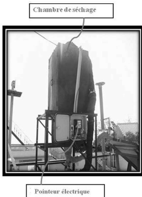
Figure G.4 : Armoire de séchage des Plantes aromatique et médicinales.
