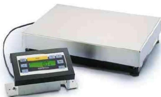
Figure G.14 : Balance de précision haute résolution avec afficheur amovible pour une flexibilité maximale (PCD 3000, Portée max 3500 g, lecture 0.01g, linéarité  $\pm 0.05$ )
