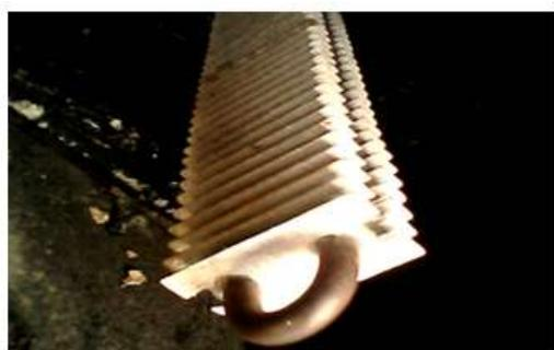
Figure G.7 : Résistance chauffante à ailettes (2Kw)
