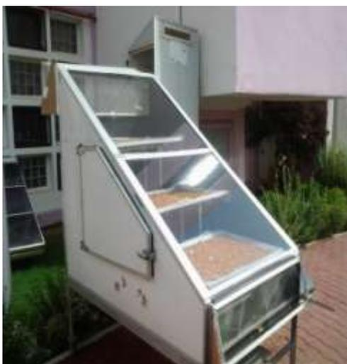
Figure A.3 : Séchoir solaire direct
