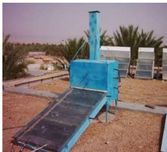
Figure A.4 : Séchoir solaire indirect à
