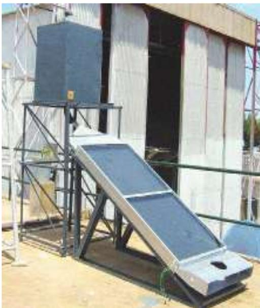
Figure A.1 : Séchoir solaire indirect
