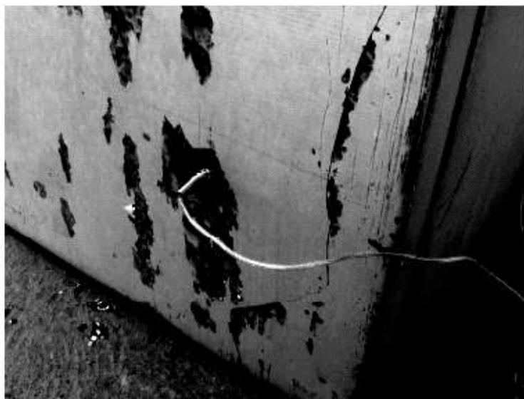
Figure G.8 : Sonde de régulation de la température de l'air asséchant placée à l'intérieur de l'armoire.
