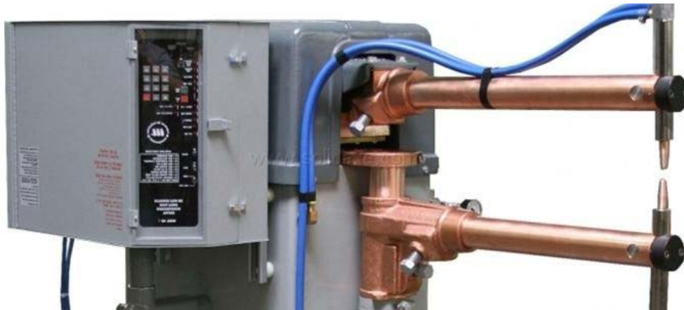
Figure 2.2 : Procédé de soudage par résistance électrique
