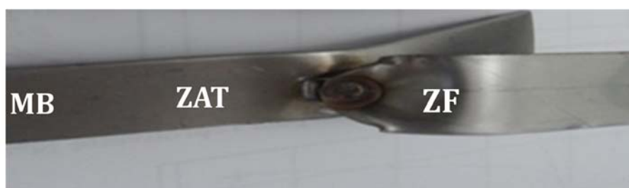
Figure 4.22 : Différentes zones obtenues après l'essai de traction
