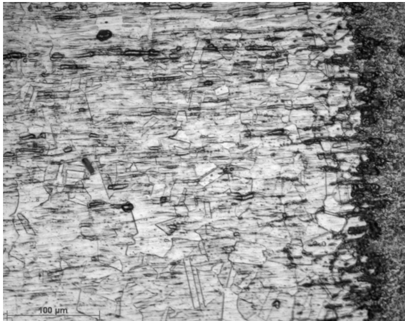
Figure 2.9 : Micrographie de la Zone affectée thermiquement (ZAT)
