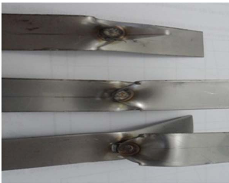
Figure 4.21 : Essai de traction sur les éprouvettes (1, 2, et 3)
