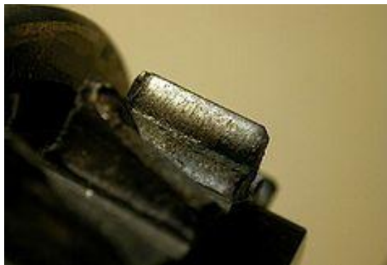
Figure 2.22 : Rupture par fatigue des engrenages
