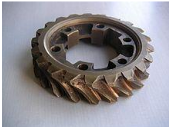
Figure 2.25 : Phénomène de grippage généralisé
