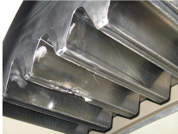
Figure 2.27 : Phénomène de fissuration
