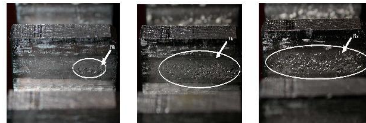
Figure 3.5 : Progression du pitting dans une denture d'engrenage [44]
