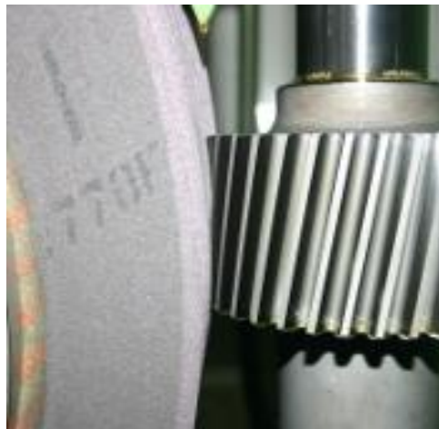
Figure 2.7 : Procédé de rectification
