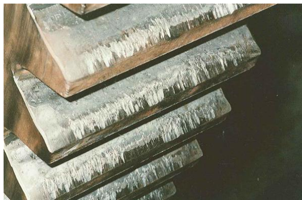
Figure 2.24 : Phénomène de grippage localisé
