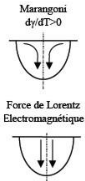
Figure 2.10 : Courants pénétrants dans le bain de fusion
