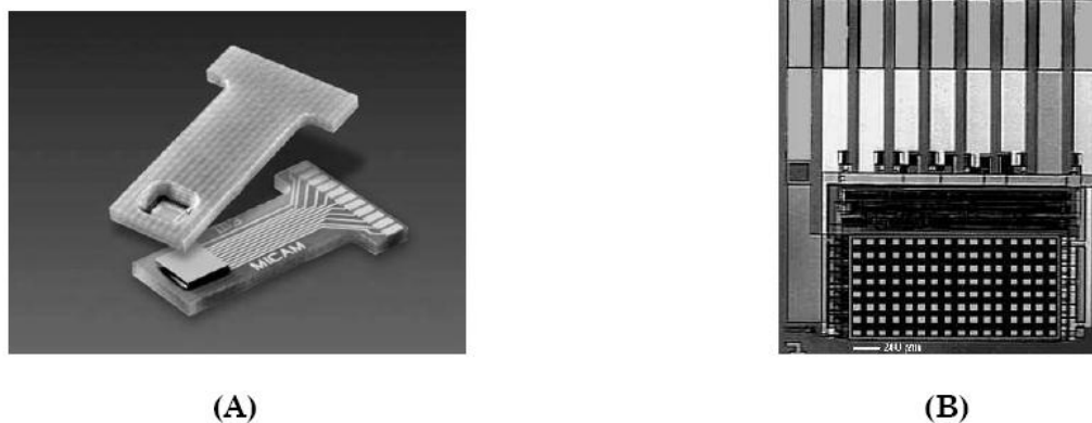
Figure 2-5 : Puce MICAM TM : image (A) de la puce, (B) des connections électriques.
