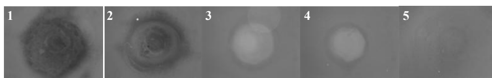
Figure 6-31 : Images en fluorescence de spots de polypyrrole biotinylé après incubation avec la streptavidine- fluorescéine.
