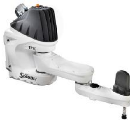
Figure 1.22 : robot SCARA (le TP80 de Staubli)
