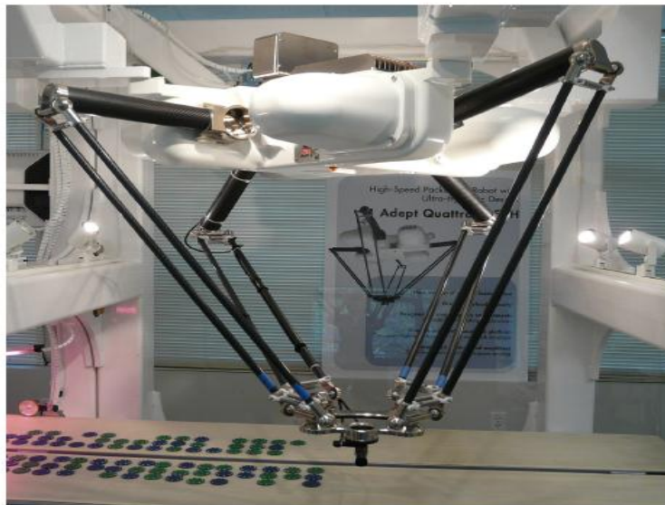
Figure 1.16 : robot parallèle (le Quattro d'Adept Technology)
