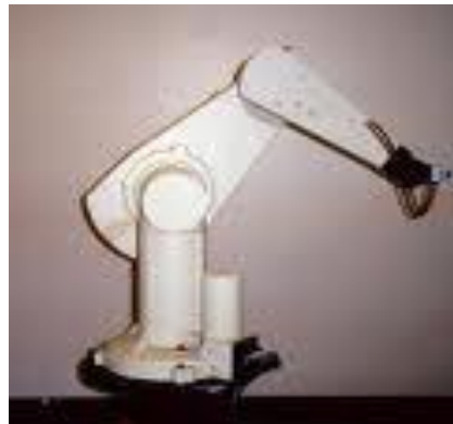
Fig. 2.22 : Bras de robot PUMA 560
