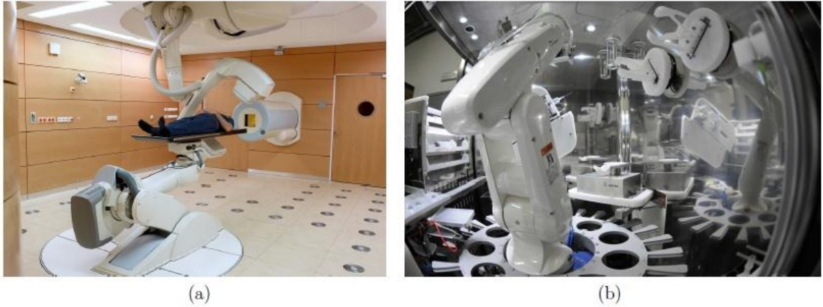
Figure 1.25 : La robotique industrielle dans les hopitaux : (a) un système développé par KUKA et Siemens Healthcare ; (b) un système pour le remplissage de seringues développé par Health Robotics
