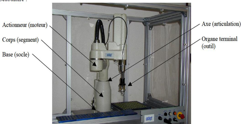
Fig.2.1 : Terminologie utilisée (Robot SCARA)
