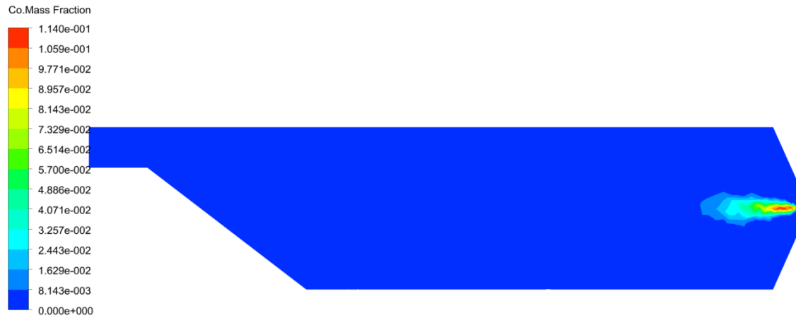
Figure (4.15) contours de la fraction massique CO" Mécanisme réactionnel réduit Méthane CH 4 "
