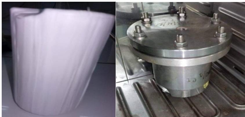
**FigureIII.8 :** Autoclave hydrothermique.
