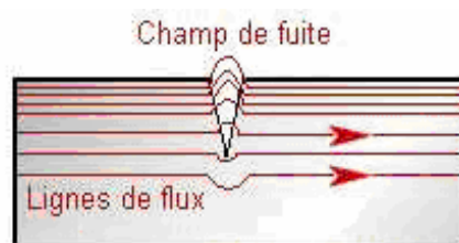
Fig.2 : Une ligne de flux traversant une pièce
