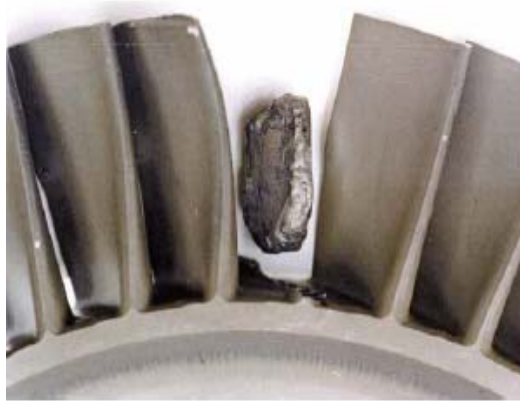
Fig.2 : Une aube mobile brisée du deuxième étage de la turbine
